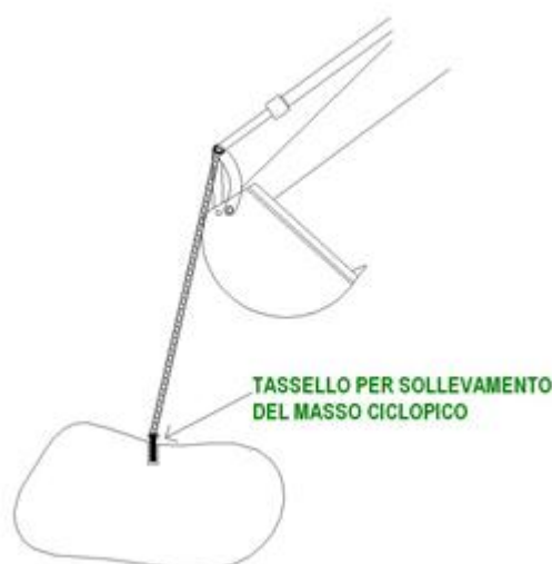
Fig. 2 – Movimentazione e posa massi ciclopici
