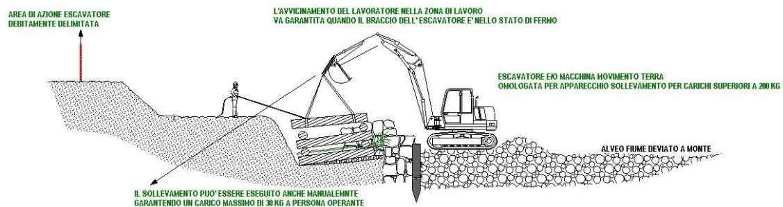
Fig. 2 – Movimentazione e posa legname
