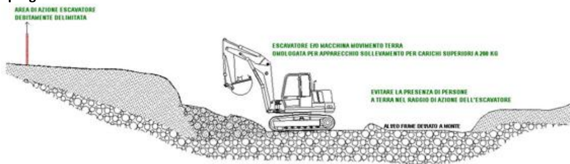
Fig. 1 – Sistemazione dei versanti laterali
