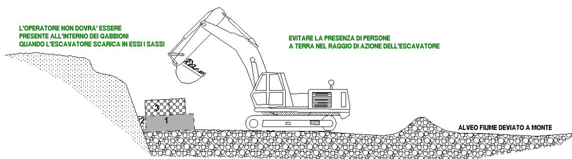
Fig. 1 – Posa dei ciotoli mediante l'utilizzo di escavatore
