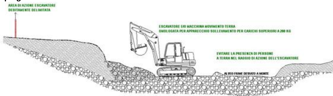
Fig. 1 – Sistemazione dei versanti laterali
