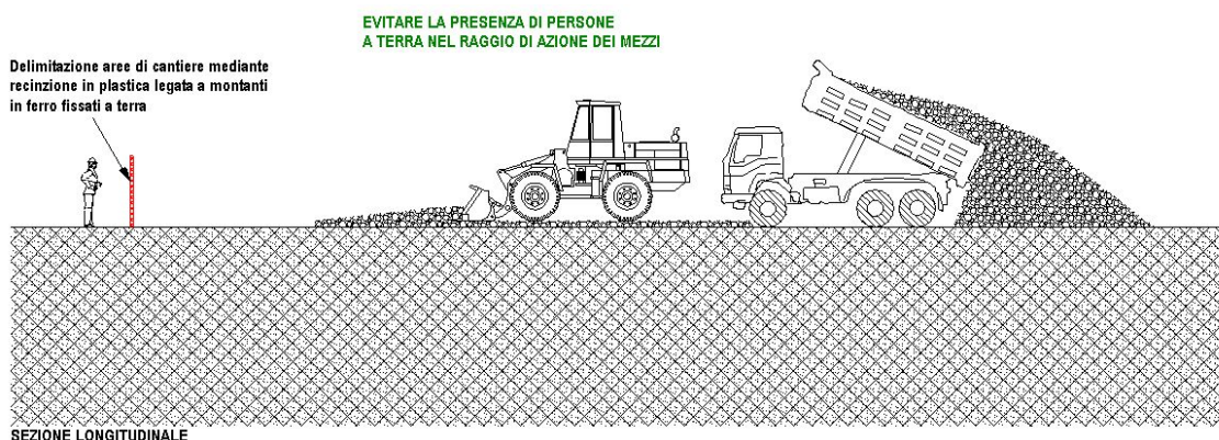
Fig. 2 – Posa strati di rilevato - Delimitazione Cantiere
