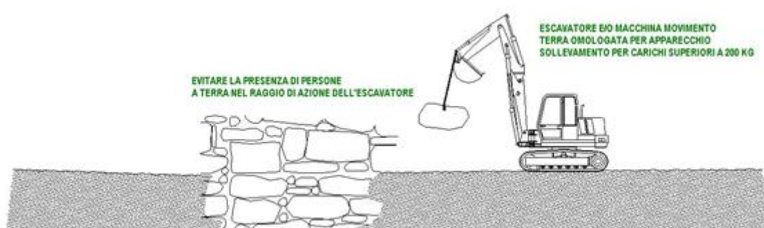
Fig. 1 – realizzazione scavo per posa soglia in pietrame – creare piste di accesso a fondo alveo costipate, ben solide e con pendenza adeguata al tipo di terreno
