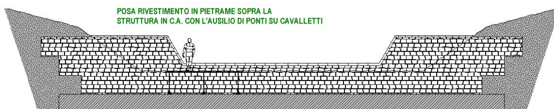
Fig. 1 - Posa rivestimento in pietrame con ausilio di opere provvisionali
