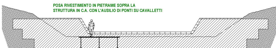
Fig. 3 – Posa rivestimento in pietrame con ausilio di opere provvisorie
